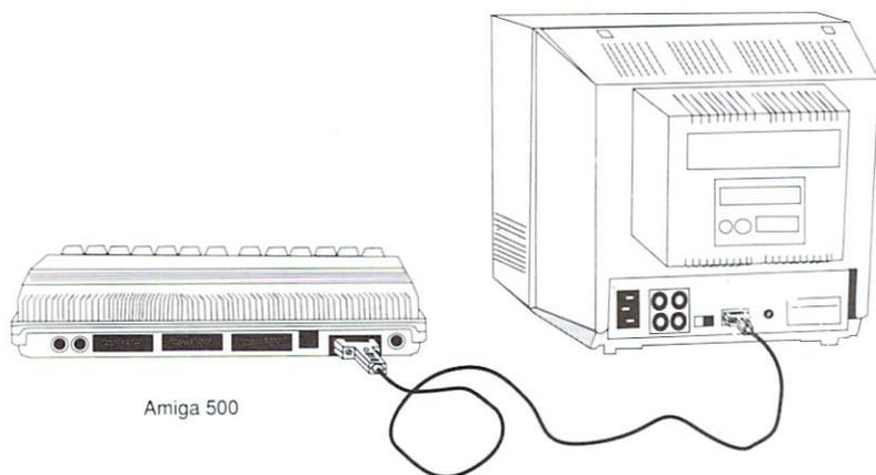
Premièrement, DÉBRAYER LE COMMUTATEUR DU MONITEUR ET L'ORDINATEUR POUR EMPÊCHER UN COURT-CIRCUIT. Ensuite, branchez le câble vidéo. Il suffit d'insérer le petit connecteur rectangulaire D à 9 broches dans la prise marquée **RGB Input** à l'arrière de votre 1084. Ensuite, insérez l'autre extrémité du câble où se trouve le gros connecteur RGB à 23 broches dans la prise vidéo l'arrière de votre Amiga. Serrez les vis qui se trouvent de chaque côté des connecteurs.
